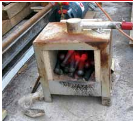
Fot. 6 Różne metody rozgrzewania nitów – piec hartowniczy (po lewej), palenisko kowalskie na koks (po prawej)
