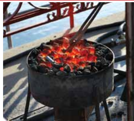
Fot. 6 Różne metody rozgrzewania nitów – piec hartowniczy (po lewej), palenisko kowalskie na koks (po prawej)
