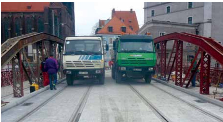
Fot. 11 Próbné obciążenie mostu południowego
