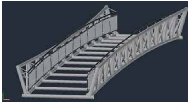
Rys. 7. Komputerowy model geometryczny konstrukcji kładki stworzony został na potrzeby wykonywania rysunków konstrukcyjnych oraz analizy geometrycznej detali kładki
