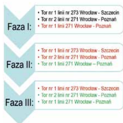
Ryc. 2. Schemat fazowania torowego dotyczącego realizacji wiaduktu nad ul. Grabiszyńską we Wrocławiu
