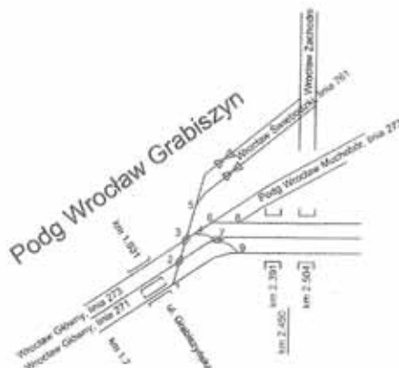
Ryc. 2. Schemat fazowania torowego dotyczącego realizacji wiaduktu nad ul. Grabiszyńską we Wrocławiu
