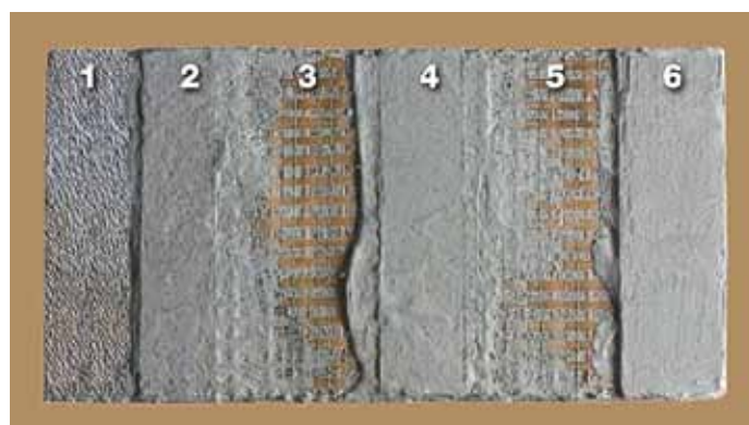
Rys.2 Budowa systemu RUREDIL X Gold Mesh
