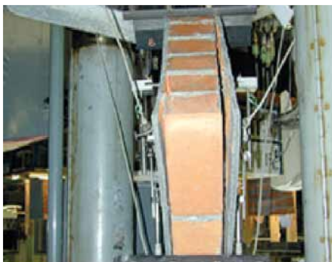
Fot. 3 Mechanizm zniszczenia próbki PM8
