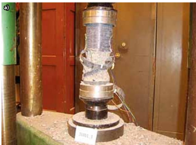
fot.1 a) obraz zniszczenia próbki – system FRP; b) obraz zniszczenia próbki – system FRCM (zdjęcia Instytutu Budownictwa Politechniki Wrocławskiej)
