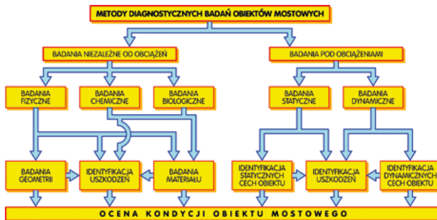
Rysunek 12. Badania niezależne od obciążeń - podstawowe technologie i techniki diagnostyczne [25]
