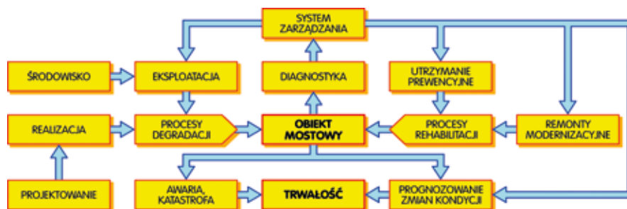
Rysunek 1. Ogólny schemat podstawowych elementów systemu zarządzania obiektami mostowymi [13]
