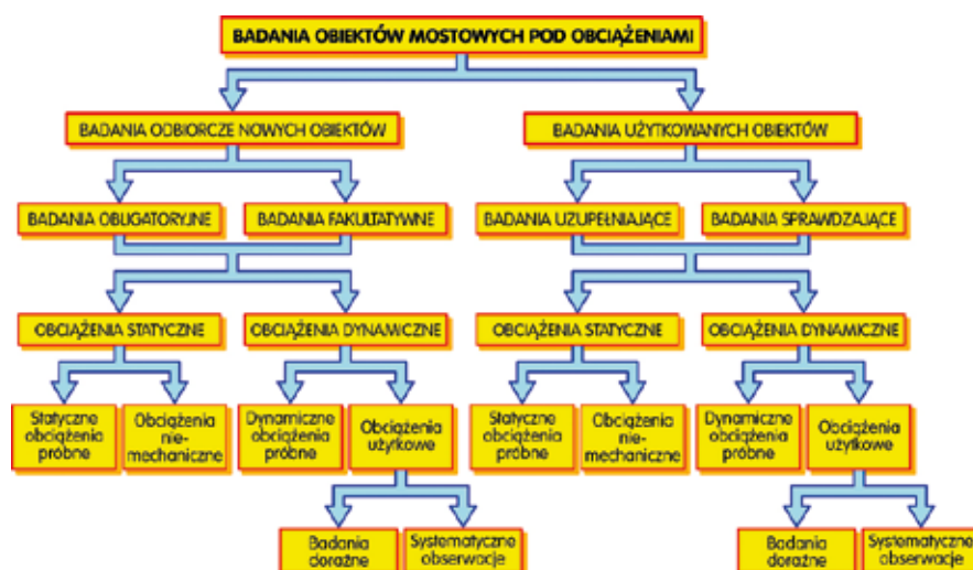
Rysunek 13. Badania diagnostyczne obiektów mostowych prowadzone pod obciążeniami [25]
