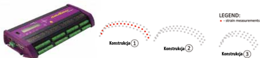
Rysunek 7. Instalacja tensometrów elektrooporowych i system pomiarowy.
