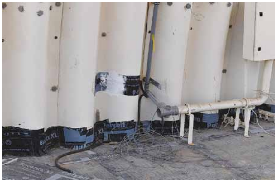
Rysunek 6. Fola Dalmierzowa naklejona na ściankę konstrukcji oraz punkty pomiarowe na wszystkich trzech łukach
