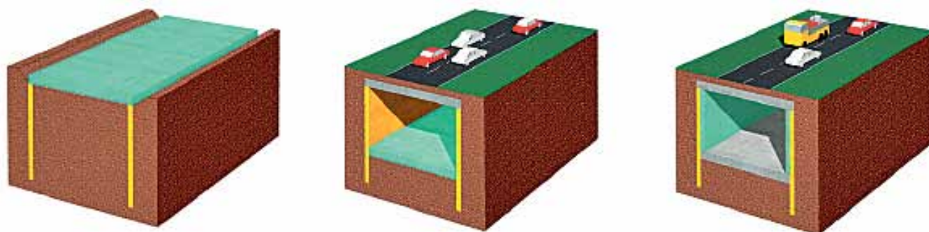
Fot.13 Schemat metody podstropowej
