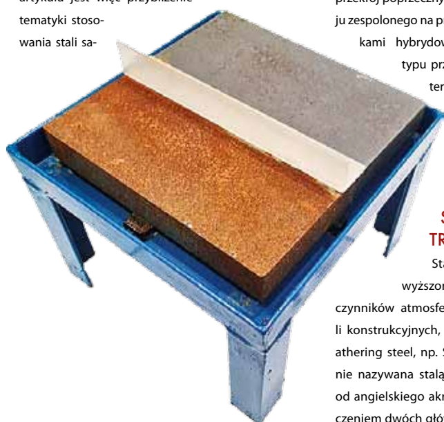
Rys. 1. Próbkę do badań wpływu środowiska na tworzenie się patyny
