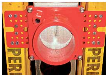
Fot. 21 Wibrator przyczepny oraz króćce do podłączenia rurociągów pomp.
