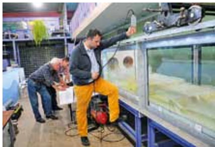
Ryc. 2. Model urządzeń zrzutowych w trakcie pomiarów laboratoryjnych. fot: Tomasz Lewandowski. Źródło: www.aqua.up.wroc.pl/aktualności/20283
