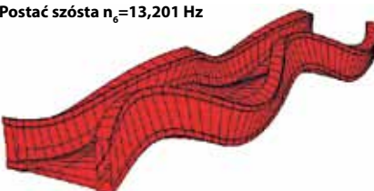
Rys.1. Formy własne i częstotliwości rozpatrywanego mostu kolejowego
