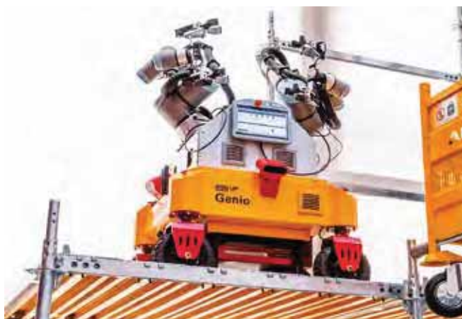
Fot.3. Czujniki w deskowaniach optymalizujące procesy na budowie oraz pierwszy robot PERI do montażu rusztowań. Zdjęcie: PERI SE.
