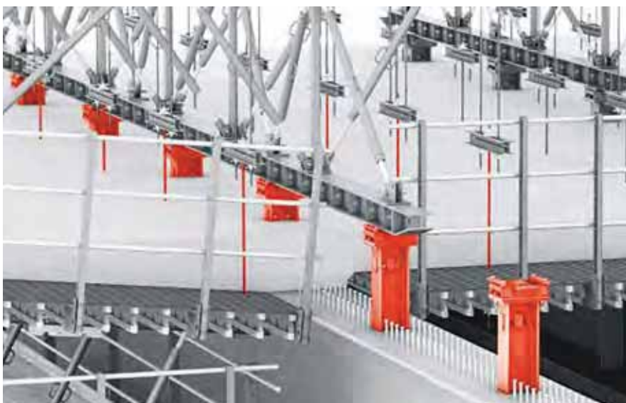
Fot.5. Klasyczne elementy wózków przejezdnych: podpory t.zw. „krzesła” oraz ściągi przechodzące przez płytę jezdnią (na czerwono).
